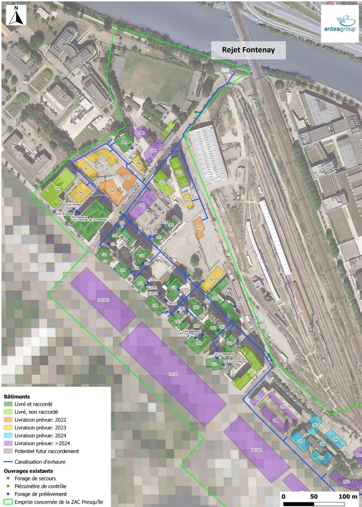
Figure 1 : Plan de l'état des lieux des bâtiments raccordés et de leurs forages de prélèvement – Zoom nord
